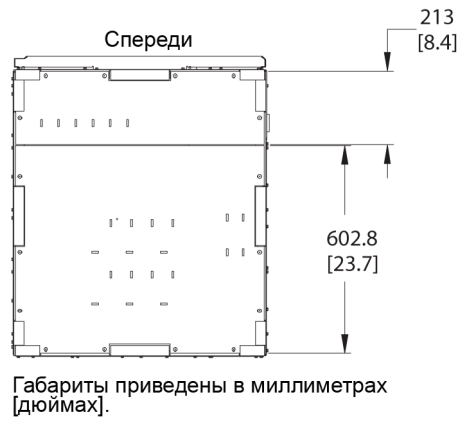
Рис. 3-4. Габариты шкафа FI-UPM (вид снизу)
